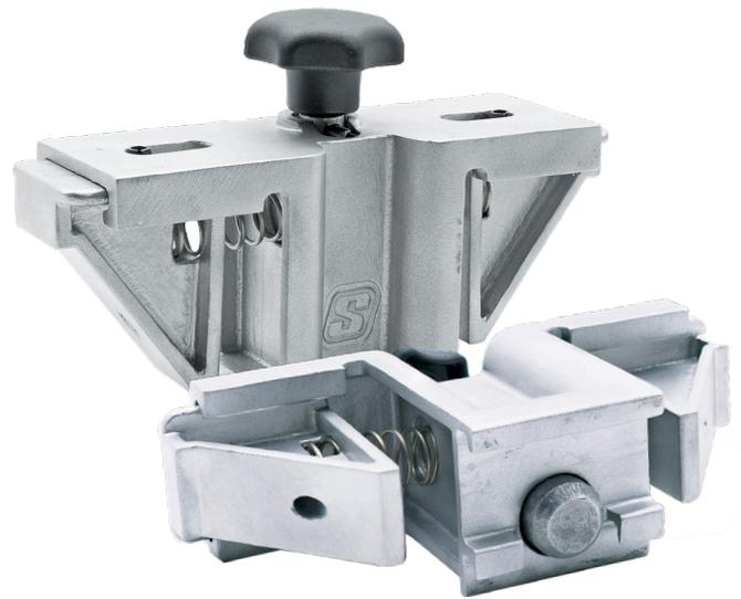
Die Rollbehältersicherung ist eine innovative Lösung zur sicheren Befestigung von Behältern in einem flexiblen System. Sie kann individuell in unsere neue Systemschiene eingehängt werden und ist in einem Raster von 25mm verstellbar. Seitliche Klemmelemente decken stufenlos Größenbereiche von 20mm bis 45mm ab und sind federnd gelagert, um das 25mm Raster der Systemschiene problemlos zu überbrücken.
